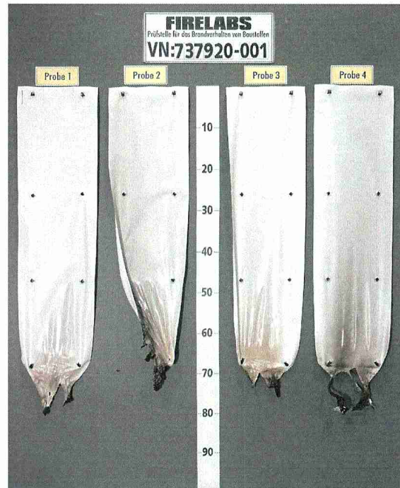
Bild 2 Aussehen des Probekörpers nach dem Brandversuch
