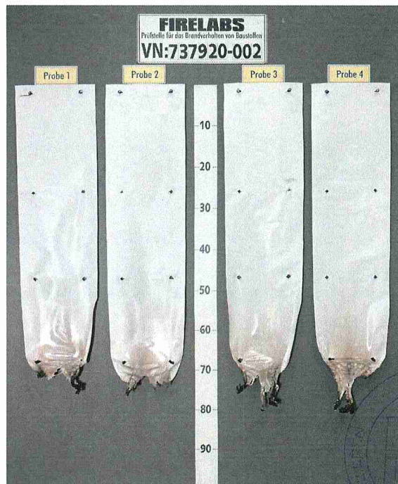
Bild 4 Aussehen des Probekörpers nach dem Brandversuch
